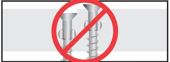
No coloque tornillos aprobados demasiado alto ni demasiado bajo en los paneles.
