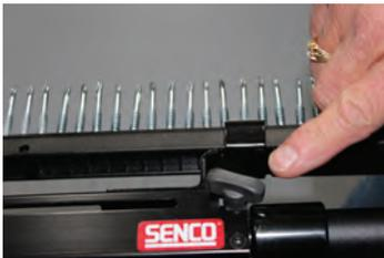
Instale el ensamble con alimentación automática deslizando por encima del tubo de extensión y apriételo con el adaptador de tornillo hasta que esté ajustado.
