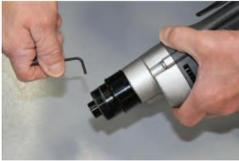
Confirme que el tornillo de ajuste del adaptador esté apretado.
