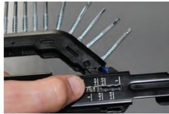
Confirme que la configuración para la longitud del tornillo sea de 2-1/4".
