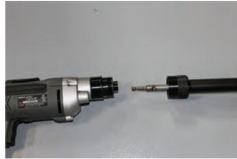
Atornille el tubo de extensión al adaptador de la pistola de tornillos.
