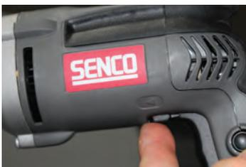
Asegúrese de que el desarmador esté operando en la dirección hacia adelante (sentido horario). De otra forma, el tornillo no avanzará y la broca se dañará.
