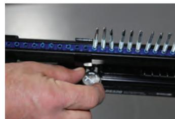
Ajuste la profundidad del tornillo girando la rueda de ajuste de profundidad manual. Consulte el gráfico en la herramienta para determinar la dirección correcta.
