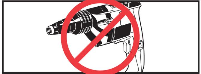
No utilice un desarmador o una pistola sin embrague o con un embrague descompuesto.
