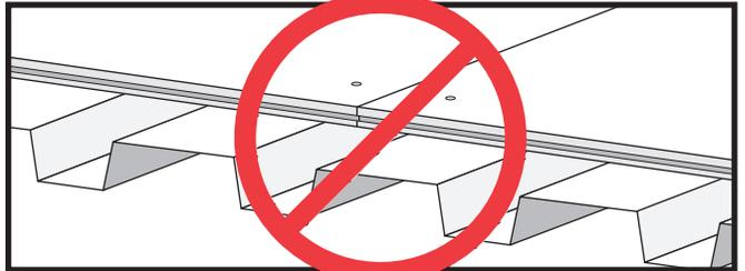
No coloque los bordes de los paneles sobre puntos en bajorrelieve (valles) de la lámina acanalada.
